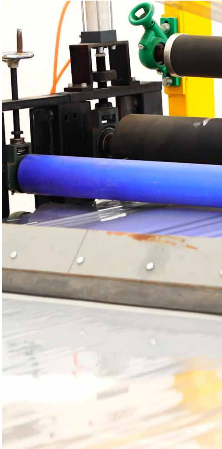
2. Se realiza el proceso de unificación donde la resina y la fibra se encuentran con la capa superior de protección uv.
