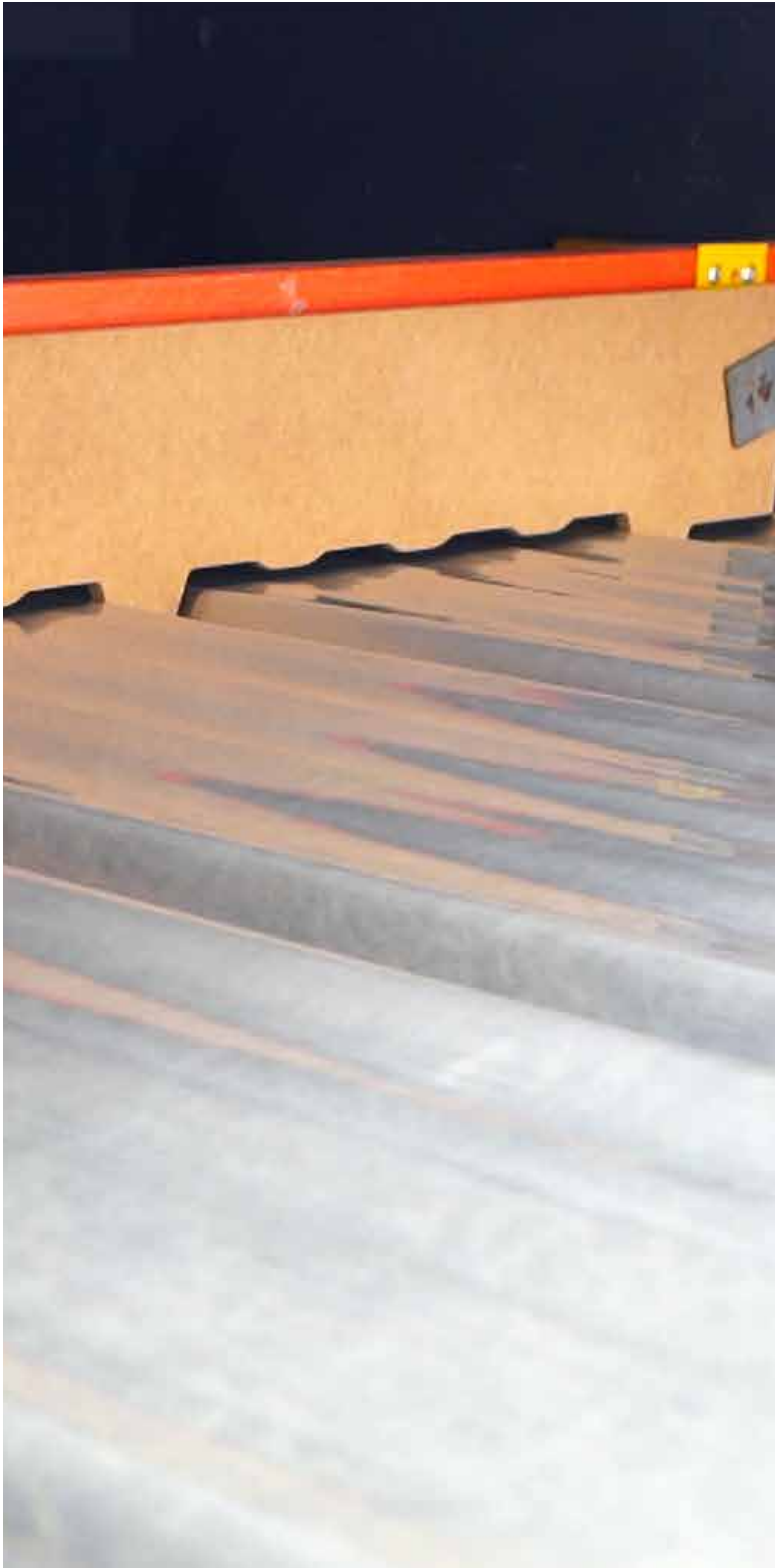
3. Se realiza el proceso de curado donde a través de una temperatura y tiempo determinado se unifican los materiales creando la cubierta.
